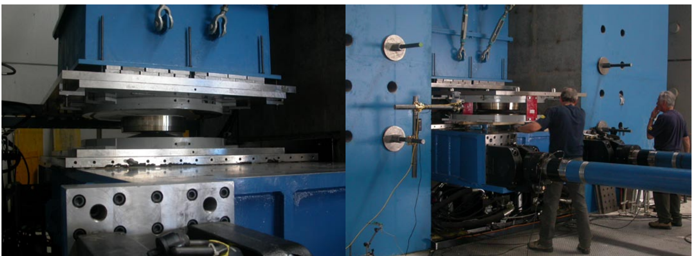
Fig. 8 Prove dinamiche su di un isolatore a doppia superficie di scorrimento presso Eucentre - Pavia Pict. 8 Dynamic test on a sliding pendulum with two sliding surfaces at Eucentre - Pavia
